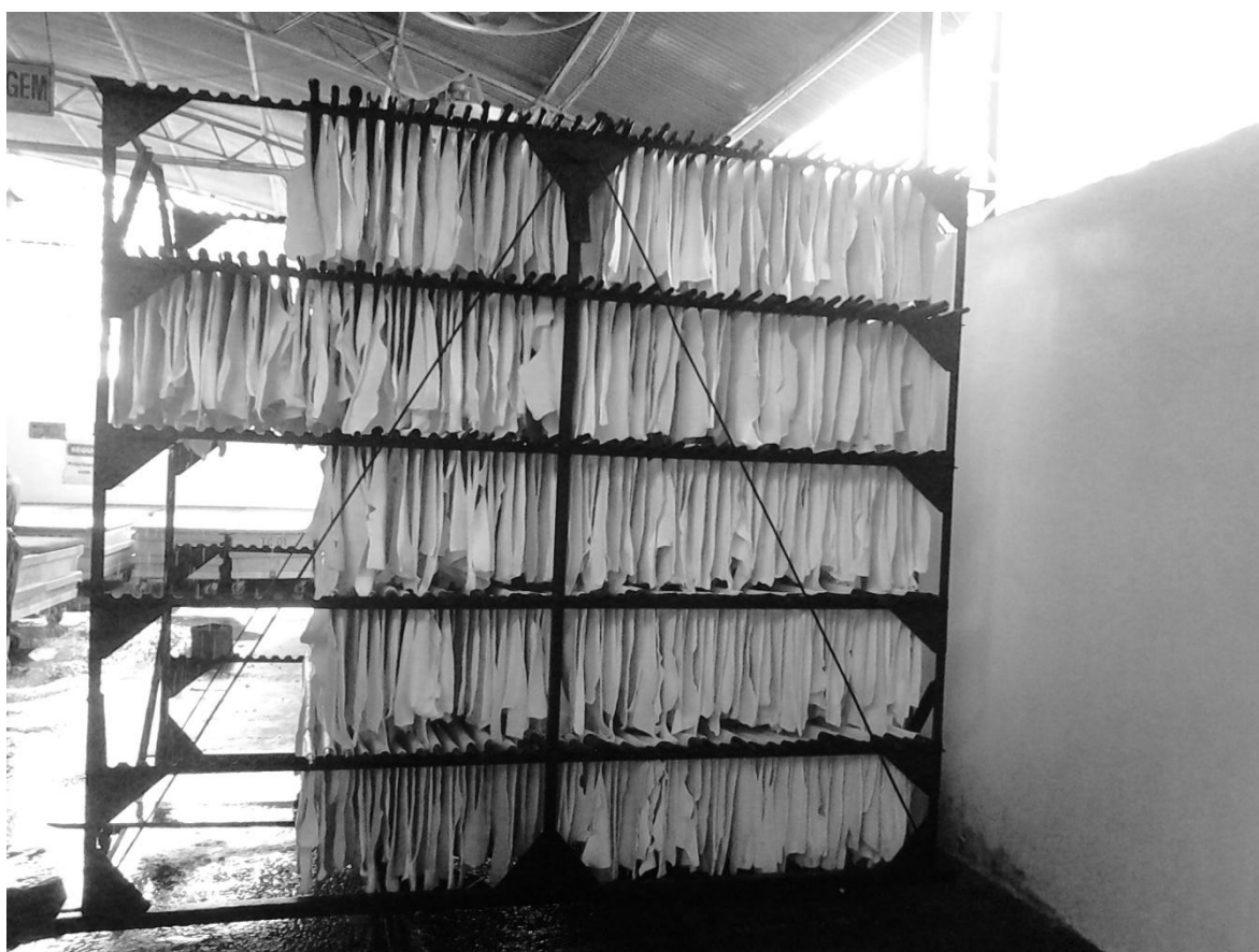
Figura 23 – Mantas de borracha crua sob secagem
